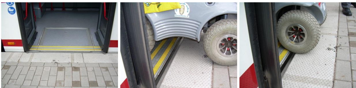
Abbildung 3: Minimierung von Restspalt und Reststufe ermöglicht Ein- und Ausstieg mit dem Rollstuhl
